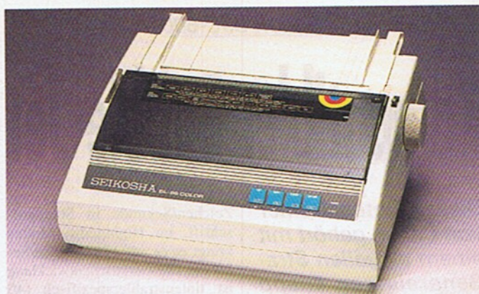
Seikosha SL-96 Color: 24-Nadel-Farbdrucker, der sich auch an serielle Interfaces anschließen läßt
