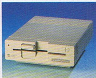
Die 1541 mit eingebauter Schreib-LED
