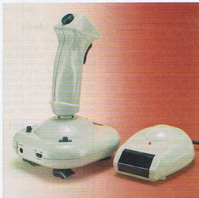
Der Remote Control macht seinem Namen alle Ehre: Durch die kabellose Infrarot-Verbindung zum Computer ist er sehr flexibel.
