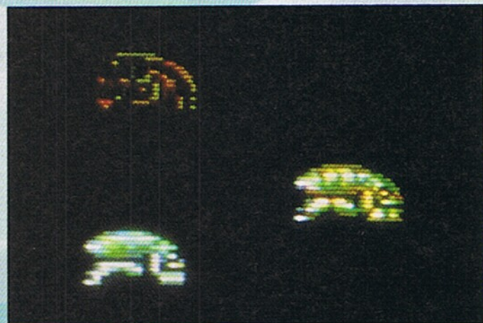
Das Spieler-Sprite (rechts) besteht aus einem Multicolor-Sprite (unten) und einem darübergelegten Hires-Sprite (oben)
