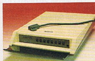
Das postzugelassene TCP 2225 AD-Modem von Digicom besitzt zusätzlich den Hayes-Befehlssatz und ein MNP5-Protokoll
