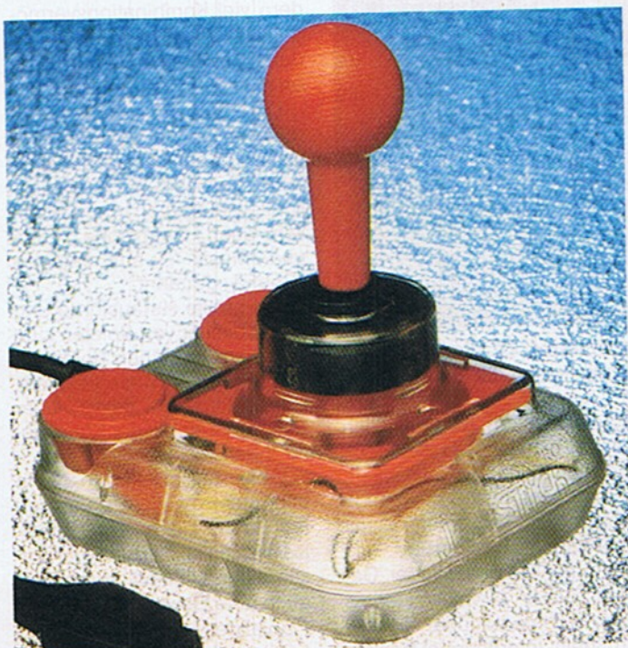
Der transparente Competition Pro zeigt, wie Spielerwünsche einen Joystick verändern können. Ihn gibt es auch mit Dauerfeuer- und Slow-Motion-Funktion.
