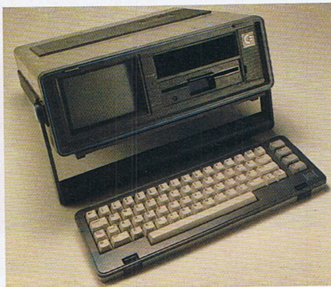
4 Der einzige tragbare Heimcomputer mit Farbmonitor und 1541: der SX 64. Der im Vergleich zum C64 hohe Preis von anfangs über 2000 Mark verhinderte jedoch seinen Durchbruch am Markt. Nach drei Jahren wurde seine Produktion eingestellt.
