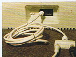
5 Umschaltbarer Anschluß der Antenne und des Computers an den Fernseher
