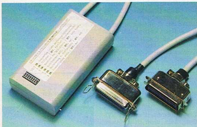
Der »Bitmaster« von RKT mit 32 KByte RAM
