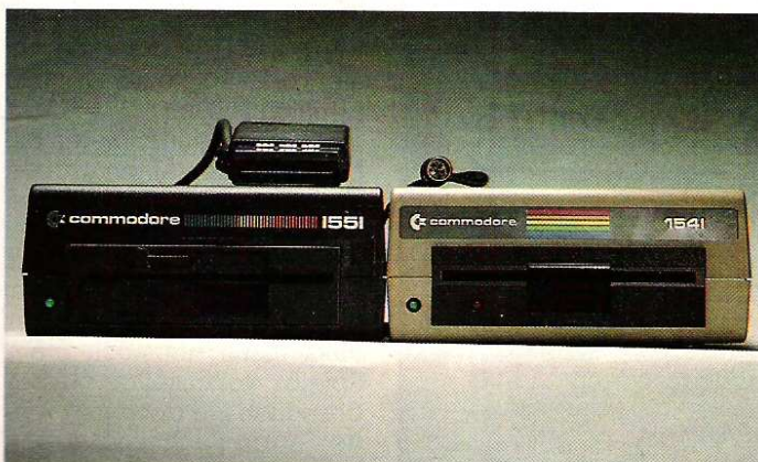
Bild 1. Die beiden Floppystationen 1551 für den C 16 und Plus/4 und die 1541 für den C 64.
