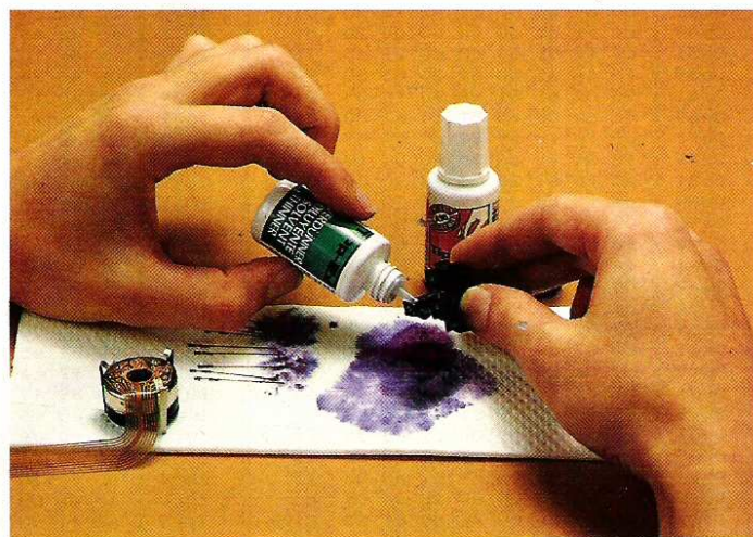
Bild 6. Die Nadeln und das vordere Kopfteil wird mit Tipp-Ex-Verdünner oder Isopropyl-Alkohol von den Farbrückständen gesäubert
