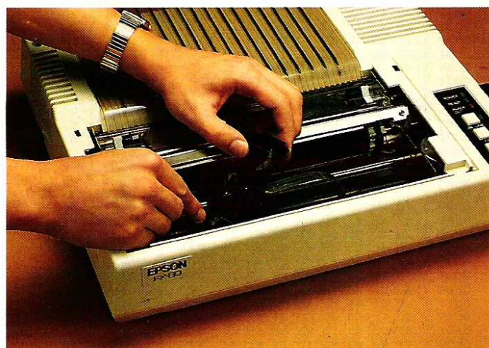
Bild 2. Der Kopf wird entfernt, nachdem die Halterung geöffnet ist. Der Druckkopf läßt sich leicht herausnehmen
