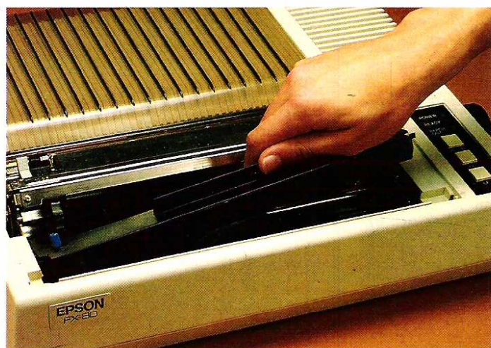
Bild 1. Entnahme der Farbband-Kassette. Lesen Sie dazu bitte den Abschnitt im Druckerhandbuch
