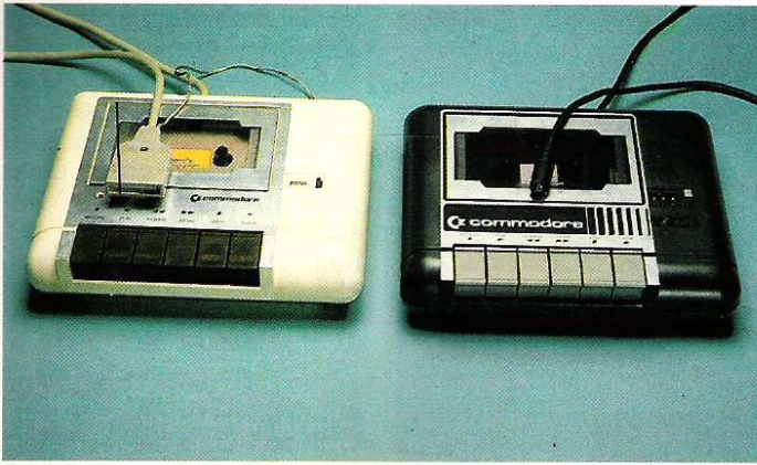
Bild 3.1 und 3.2. Die beiden Datasetten von Commodore sind bis auf die Stecker und unwesentliche Details absolut identisch. Die Laufwerksmechanik ist von einem jeweils anderen Hersteller und wurde geringfügig modifiziert.
