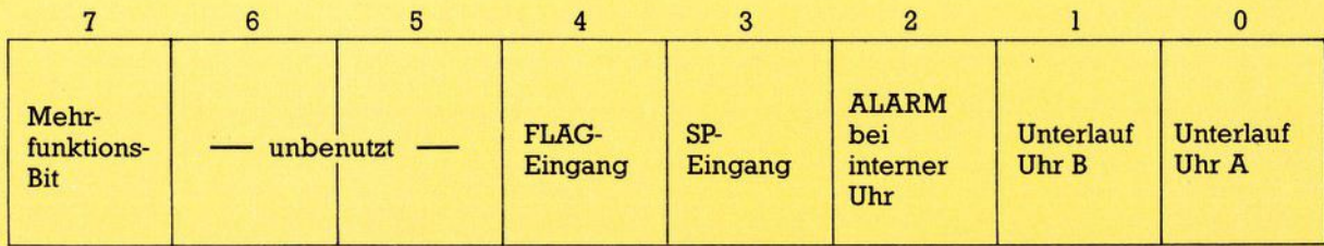
Bild 5. Genereller Aufbau der Unterbrechungs-Kontroll-Register (13) der beiden CIA-Bausteine
