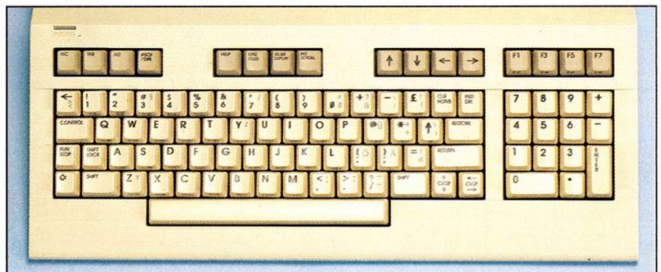
Bild 4. Die Tastatur ist funktionell und ergonomisch aufgebaut. Der deutsche Zeichensatz wird durch die Umschalttaste ASCII/DIN erreichbar. Die Belegung der Tasten entspricht dann den DIN-Normen. Die Bezeichnungen sind bereits auf den Tastenkappen aufgedruckt. Durch diesen Zeichensatz ergibt sich teilweise eine fünffache Belegung einzelner Tasten. Doch diese Tatsache wird dann gerechtfertigt, wenn es speziell auf den deutschen Markt zugeschnittene Textverarbeitungsprogramme geben wird (und vielleicht auch einen Drucker von Commodore, der die deutschen Umlaute von Haus aus beherrscht).
