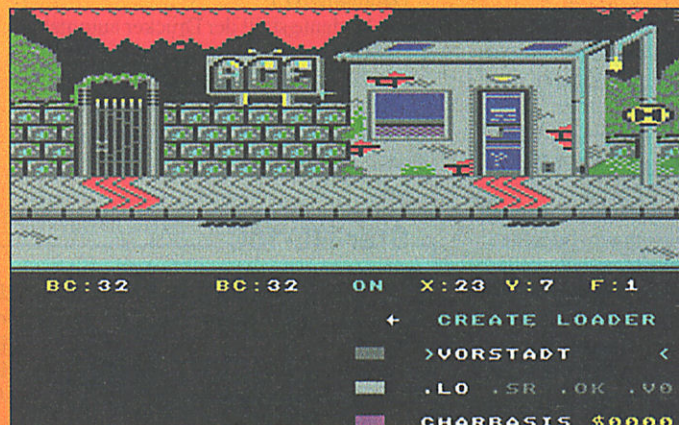
Die Level lassen sich komplett mit einem Loader sichern - dabei müssen Sie die Adressen für Zeichensatz, Bild- und Color-RAM angeben
