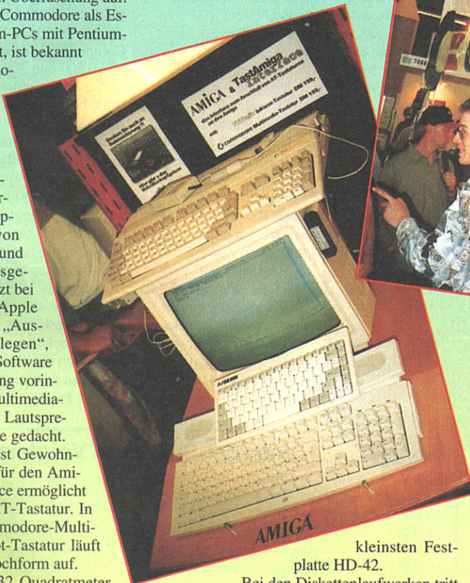
Unten: Was für den C 64 bereits Gewohnheit ist, gibt es nun auch für den Amiga: ein Interface zum Anschluß von PC-Tastaturen
