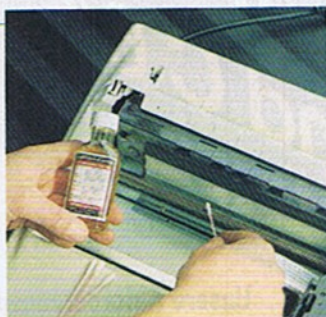
Diese Führungsstange ist mit einem (!) Tropfen Öl zu schmieren
