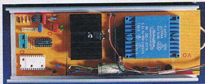
2 Netzteil und A-D-Wandler im hinteren Teil des Gehäuses
