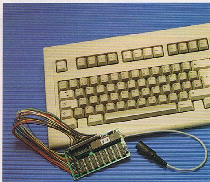
Eine gewöhnliche XT-Tastatur wird über den Adapter (im Vordergrund)
