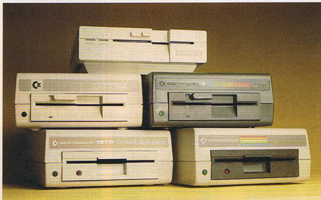
Bild 7. Die Floppy-Stationen der Commodore-Heimcomputer. Bis auf die 1571 (ganz oben) arbeiten sie einseitig und verfügen über zirka 170 KByte (1571: 340 KByte) Speicherkapazität.
