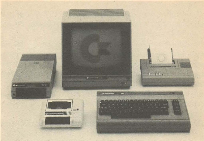
Abb. 1: Eine typische Systemkonfiguration: Commodore 64, 1701 Monitor, 1520 Drucker, 1541 Diskettenlaufwerk, Datassette-Rekorder.
